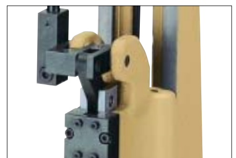
Umgesteckter ERGOPRESS® Handhebel für Bedienung durch Linkshänder
